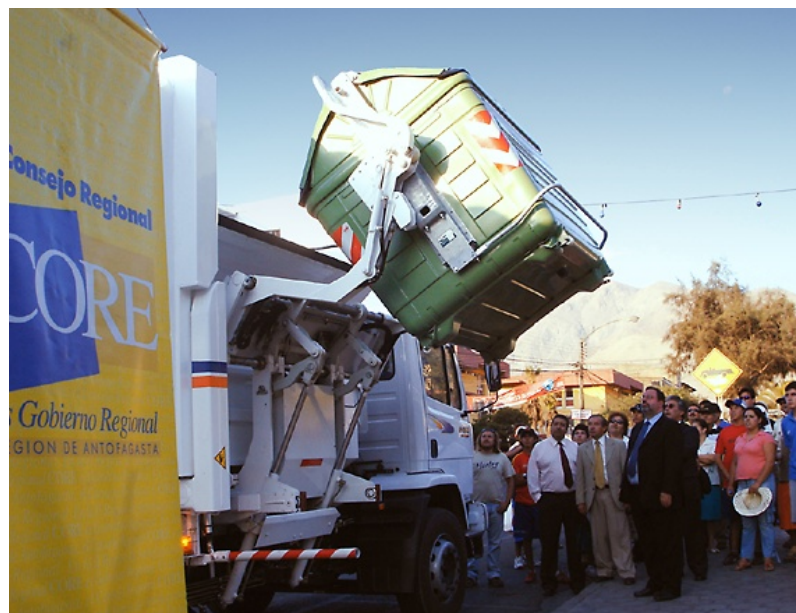
En la Plaza de Armas de Tocopilla los habitantes de la comuna pudieron conocer el funcionamiento del nuevo sistema de recolección de residuos domiciliarios, incluyendo una demostración del sistema de carga lateral de contenedores.
